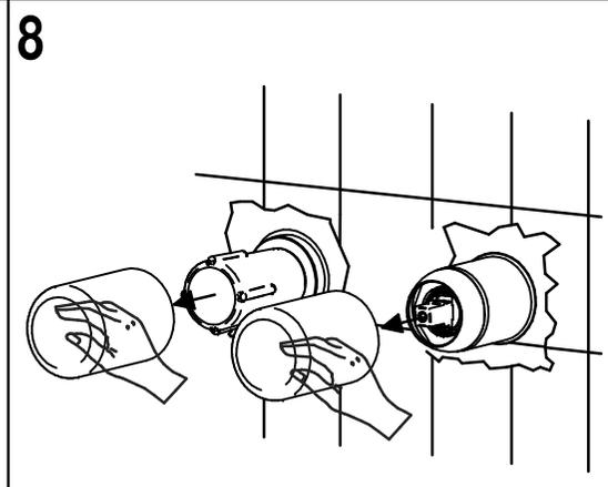
**Per installatore: Al fine di garantire la durata del prodotto installare rubinetti con filtro da pulire periodicamente. Effettuare risciacquo delle tubazioni prima di installare il prodotto (PUNTO 1). Eventuali residui se finissero all'interno della cartuccia potrebbero causarne il danneggiamento**
